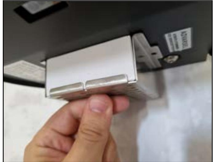
2. Placer le filtre sur les trous de la sortie d'air.
