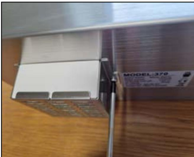
3. Monter et serrer complètement les vis de sécurité des deux côtés.
